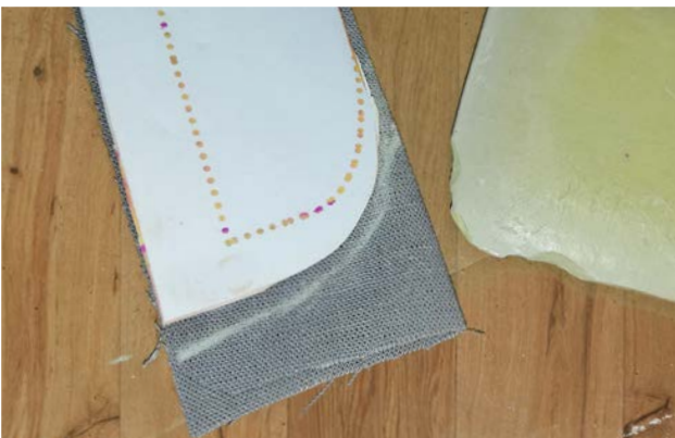
RV11. Die Rundung auf den Untertrittbeleg zeichnen. Z11. Draw the curve on the underlap facing.
