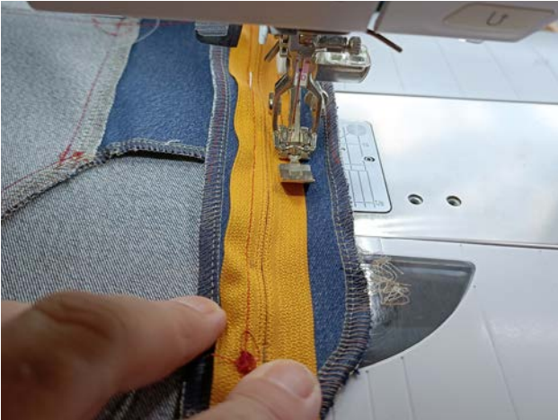
RV9. Den RV auf dem Beleg festnähen. Z9. Stitch the zipper to the facing.
