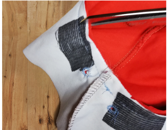
6. Naht an den Rundungen einschneiden, wenden und ausbügeln. 6. Clip the seam at the curves, turn it inside out, and press it.
